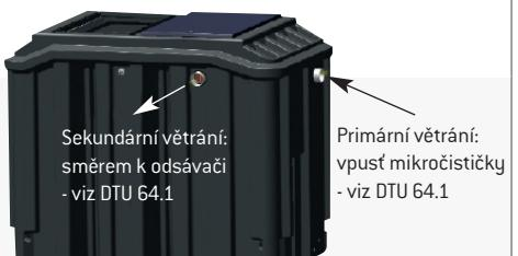
Přívod vzduchu je zajištěn prostřednictvím spádového potrubí odpadních vod přes primární větrání o jeho průměru (min. 100 mm) až na volný vzduch a nad obydlené prostory. Fermentační plyny se musí odsát pomocí větracího systému vybaveného statickým nebo větrným odsavačem umístěným 0,40m nad krovem a alespoň 1m od střešního okna a jakékoli jiné ventilace.
