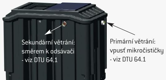
Přívod vzduchu je zajištěn prostřednictvím spádového potrubí odpadních vod přes primární větrání o jeho průměru [min. 100 mm] až na volný vzduch a nad obydlené prostory. Fermentační plyny se musí odsát pomocí větracího systému vybaveného statickým nebo větrním odsavačem umístěným 0,40m nad krovem a alespoň 1m od střešního okna a jakékoli jiné ventilace.
